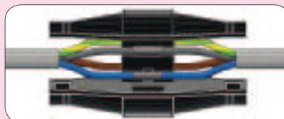
Plaatsing van vulringen en de afsluiting van het kabelmof.
